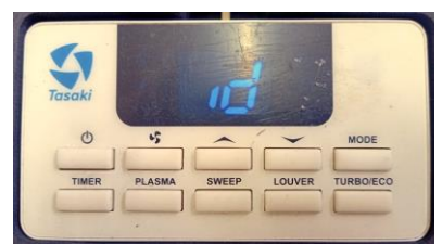
2. กดปุ่มเพิ่มค่าและลดค่าพร้อมกันค้างไว้ 5 วินาที หน้าจอจะแสดงค่า "id" ปล่อยมือ
