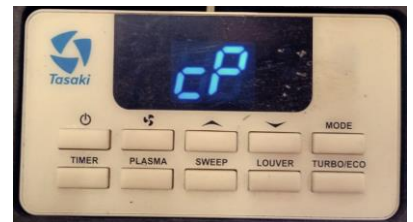
5. กดปุ่ม Mode ค้างไว้เพื่อบันทึกค่าที่ตั้งไว้ และออกจากการตั้งค่า
